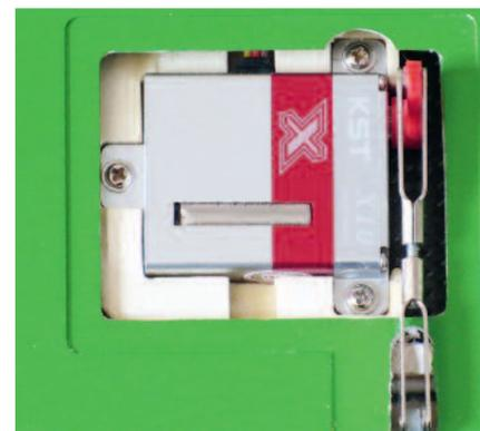
Mit den im Lieferumfang enthaltenen Servorahmen für die KST X10 gelingt der Tragflächen-Servoeinbau von Querruder und Wölbklappe problemlos.
